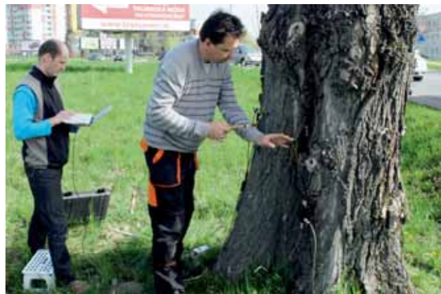
Pracovníci Marek Kobza a Radovan Ostrovský inštalujú senzor akustického tomografu na strom.
