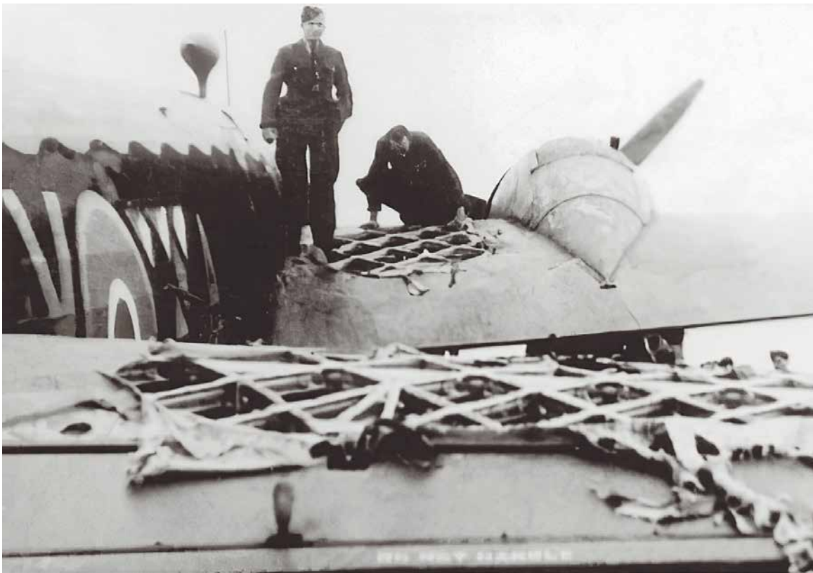
Poškodenie lietadla Josefa Stránskeho po zásahu flakom pri bombardovaní Brém v júni 1942
